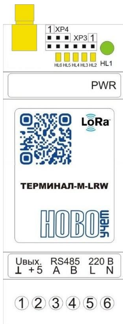
Рисунок 3.1 – Расположение контактов Модуля
