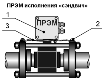
1 – электронный блок; 2 – винт М5; 3 – выравнивающий токопровод
